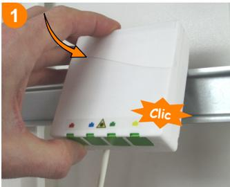
Clipper le DT10 sur le rail DIN dans le coffret.
