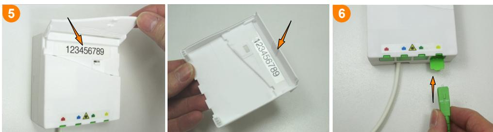
5 Poser les étiquettes d'identification sur le capot (une étiquette collée sous la trappe et l'autre collée à l'intérieur du capot).
