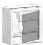
Démonter et remonter la fenêtre en la bombant légèrement afin de dégager les axes de rotation.
