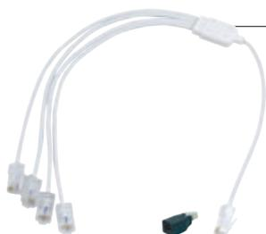
Le cordon quadruple téléphone/RJ45 sert à quadrupler les sorties téléphone issues du filtre maître ou de la box. Il est composé d'une entrée RJ45 et de 4 sorties RJ45. Il est livré avec un adaptateur RJ11/RJ45 pour pouvoir l'utiliser sur les anciens filtres maîtres munis de sorties RJ11. Sa longueur de 60 cm permet un usage dans tous les coffrets de communication. Le cordon est réalisé à partir d'un câble 1 paire torsadée.
