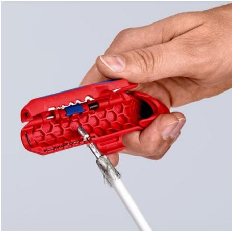
Dénudage d'un câble coaxial
